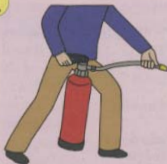
ดึงสาย และเอาหัวดับเพลิงชี้ไปทางที่เกิดไฟไหม้
